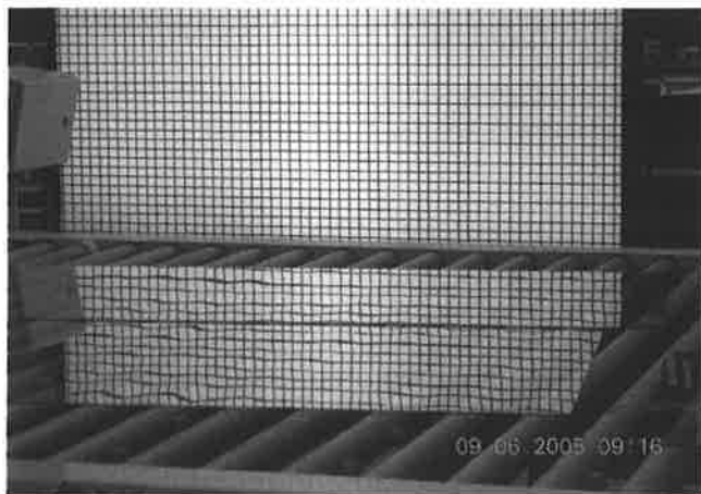
Kuva 2. Tela-aalloista johtuva lasin pinnan heijastuman vääristymä.
