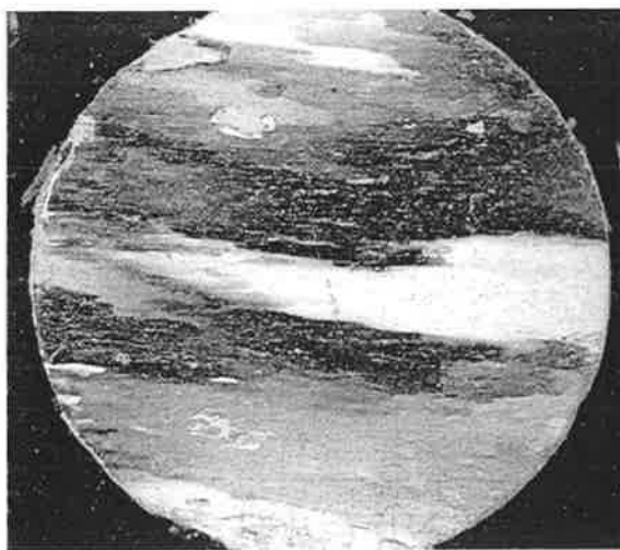
Kuva 2. Jään ohuthie kiderakenteen ja c-akselin määrittämistä varten.
