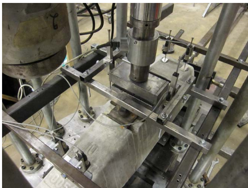
Kuva 3 Pölkyn pään koejärjestely.
