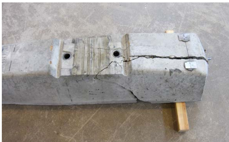
Kuva 6 Väsytytkuormituskokeiden jälkeisessä staattisessa kuormituskokeessa pituussuuntaisesti haljennut pölkky.
