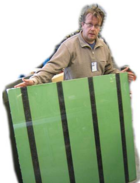
Kuva 4. Tutkitut jaksolliset paneelit: vasemmalla kirjoittajista Aalto raitapaneelin kanssa, oikealla ruutupaneeli asennettuna kaiuntahuoneen mittausaukkoon ääneneristävyden mittausta varten.
