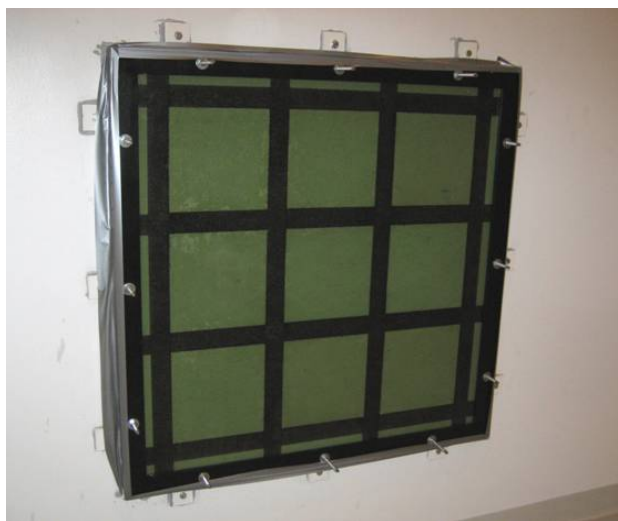
Kuva 4. Tutkitut jaksolliset paneelit: vasemmalla kirjoittajista Aalto raitapaneelin kanssa, oikealla ruutupaneeli asennettuna kaiuntahuoneen mittausaukkoon ääneneristävyden mittausta varten.
