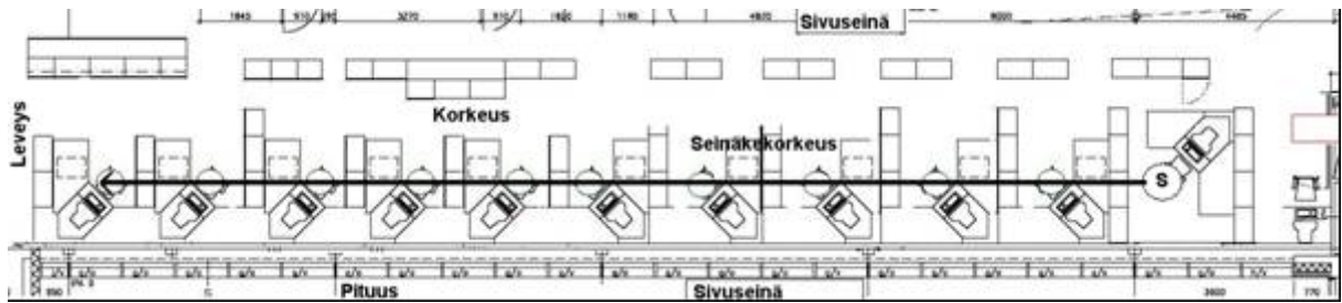
Kuva 1. Esimerkki mittauslinjasta avotoimistossa (nuoli äänilähteestä S pois päin). Mittaukset suoritetaan aina työpisteissä, vaikka ne eivät sijaitisi täsmälleen suoralla mittauslinjalla.
