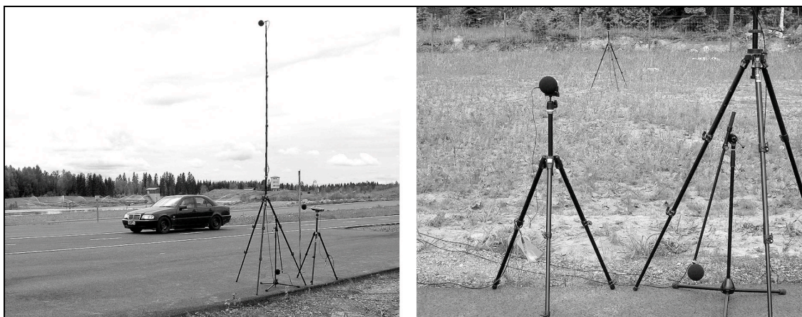
Kuva 1. Mikrofonit Nokian Renkaiden koeradalla. Oikean puoleisessa kuvassa näkyy taustalla kaukopisteen mikrofoni.
