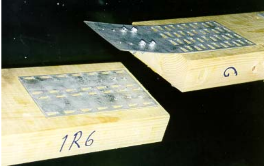
Kuva 11. Porakärkisillä peltiruuveilla koottava naulalevyrakenteen työmaaliitos [13]. Naulalevylitoksen täysi kapasiteetti saavutetaan muutamalla ruuvilla.
