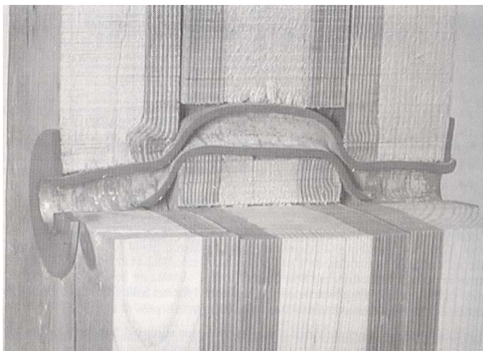
Kuva 8. Leikepintoihin liimatuilla kokoonpuristetuilla pyökkivanereilla vahvistettu putkivaarnaliitos avattuna kuormituskokeen jälkeen, Leijten [1]. Asennuksessa putkivaarnat laajennetaan puristamalla, jolloin liitoksen alkujäykkyys on hyvä. Vahvistetulla liitoksella on suuri kapasiteetti ja putkivaarnan muodonmuutoskyvyn vuoksi se on myös erittäin sitkeä.
