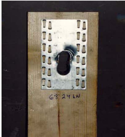
Kuva 9. Murtoon kuormitettu naulalevyillä vahvistettu pulttiliitos [11].
