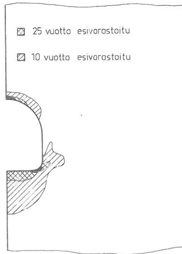
Kuva 6. Lämpökuorman vaikutus myötöön ( c = 15 \text{ MPa} )
