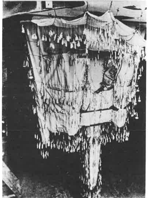
Kuva 13. Gaudin köysikulmion kääntösääntöön perustuvat pienoismallit. a) kuormitettu verkko. b) Kuormitettu kirkon kalvomalli.
