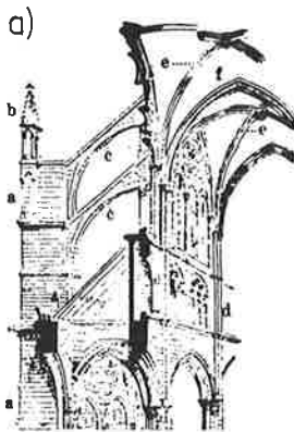
Goottilainen tukirakenne. a tukipilari, b faali, c tukikaaria, d triforioparvi, e holvituode, f holvi-vaippa.
