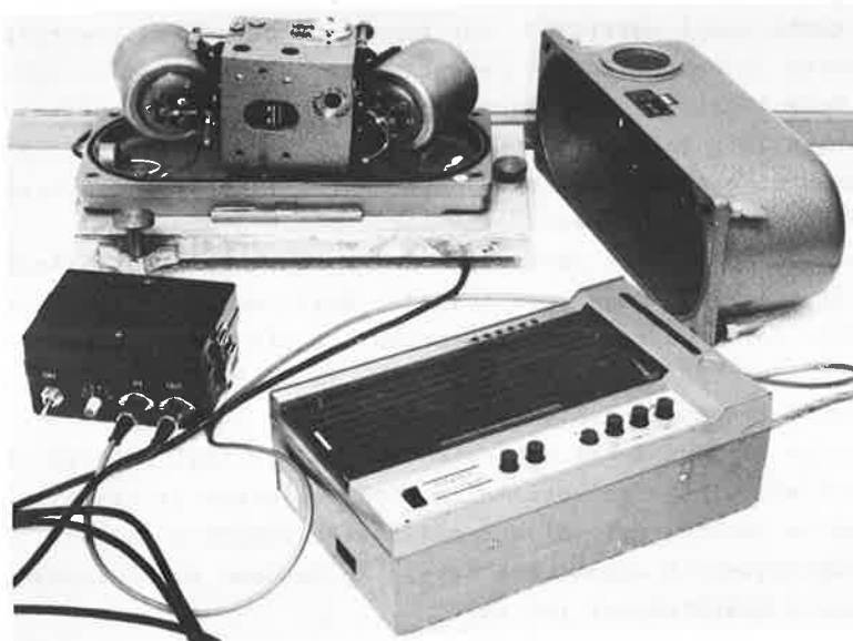
Kuva 1 Ominaisperiodin mittauksiin käytetty siirreltävä seismografikalusto. C5C-horisontaaliseismometri, vahvistin, suodatinyksikkö ja Rapet RMS-11 -piirturi.
