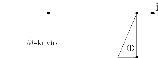
Kuva 7.14 Portaali-kehän eräs virtuaalinen momenttijakauma pisteen 4 yksikkökuormasta.
