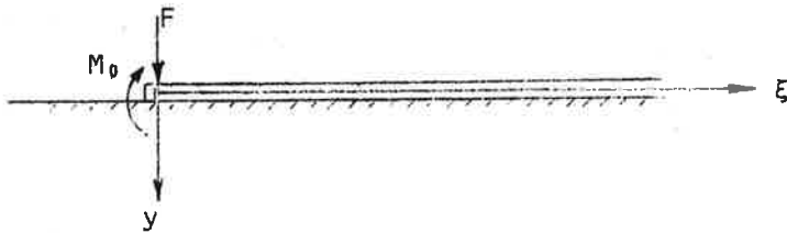
Kuva 8. Pistekuorman ja voimaparin kuormittama palkki.
