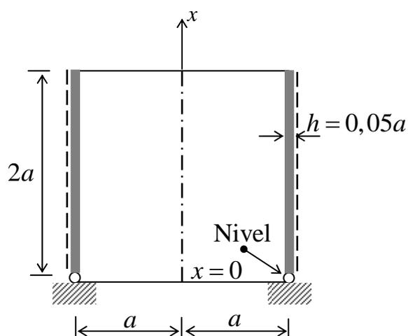
Määritä oheisen sylinterikuoren normaalivoiman  $N_\phi(x)$  ja taivutusmomentin  $M_x(x)$  lausekkeet sen omasta painosta, kun kuoren tiheys on  $\rho$ , kimmomoduuli on  $E$  ja Poissonin vakio on  $\nu = 0,3$ . Piirrä dimensiottomat lausekkeet  $N_\phi / (\rho g a^2)$  ja  $M_x / (\rho g a^3)$  funktiona dimensiottomasta koordinaatista  $x/a$ . Määritä lopuksi näiden suureiden itseisarvoltaan suurimmat arvot.
