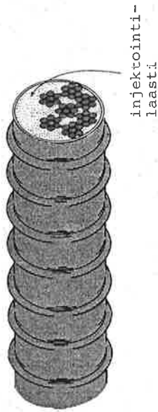
(a) Injektoitu, poimullinen suojaputki, jonka sisällä monipunosjänne
